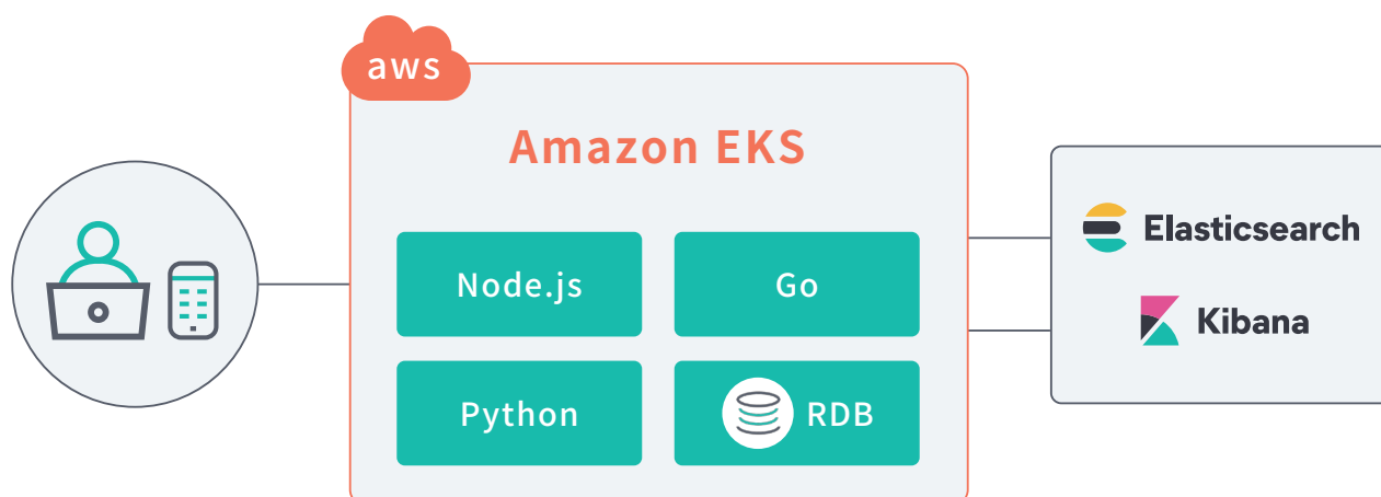
図：MeeTruck のサービス基盤は CQRS アーキテクチャに基づいて書込用 DB と検索用 DB を分け、後者に Elasticsearch を採用して高速な Web サービスを実現している
